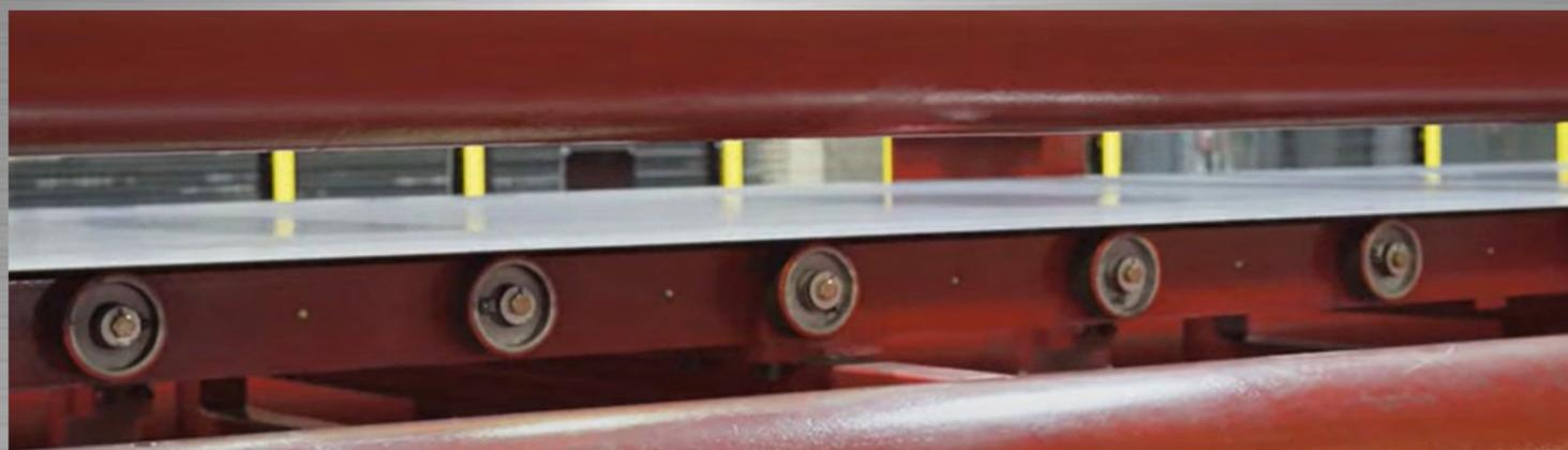
Компания закупает листовой металл напрямую у производителей, либо получает на переработку от клиента. Со склада сырье поступает на две раскройные линии продольной и поперечной резки, где осуществляется обработка металла как по стандартным типоразмерам, так и по индивидуальному заказу.
